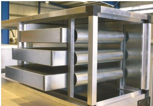
Les pièges à sons sont faits de baffles parallèles, extractibles latéralement pour le nettoyage. Les baffles sont réalisées en mousses acoustiques absorbantes lavables, évitant la désagrégation et le « relarguage de fibres » dans le flux d'air, et autorisant un entretien périodique. Le bord d'attaque d'entrée d'air sur les baffles est aérodynamique limitant ainsi la perte de charge.
